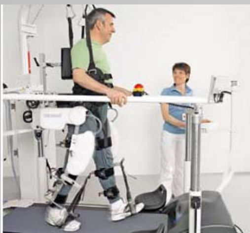
Figura 9. Sistemul robotic de rehabilitare pentru asistenta a mersului (Lokomat Treadmill Walker) [16]
