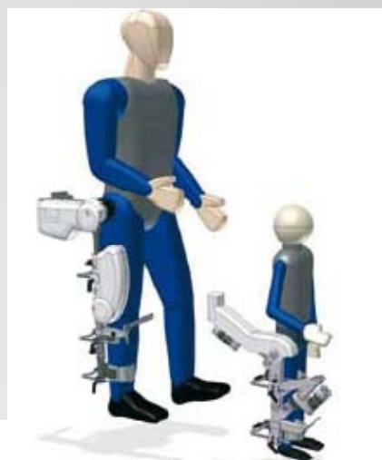
Figura 10. Structura sistemului robotic de rehabilitare de tip Lokomat și aspect privind adaptarea acestui sistem pentru recuperarea copiilor cu dizabilități locomotorii [16]
