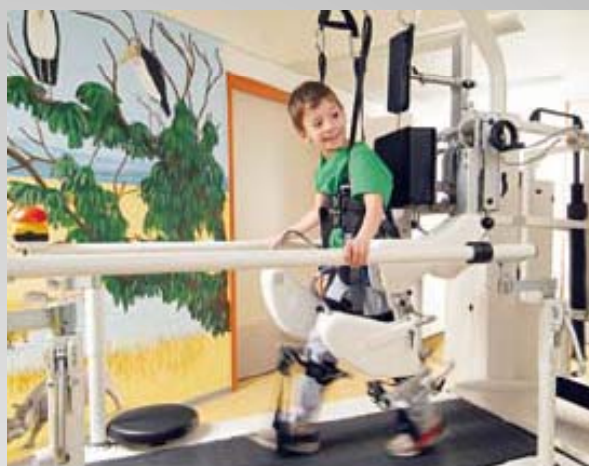
Figura 9. Sistemul robotic de rehabilitare pentru asistenta a mersului (Lokomat Treadmill Walker) [16]
