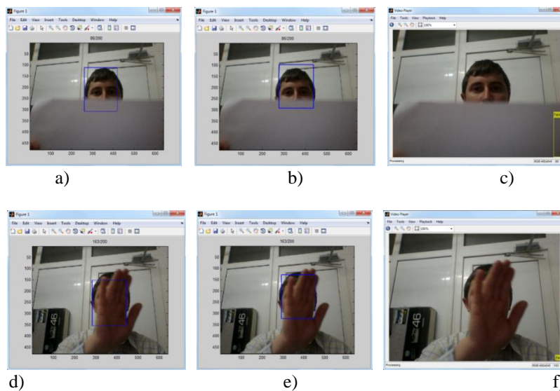
Fig. 5.23 Rezultatele urmării în cadrele 86 și 163 din secvența video 2 prin metodele: CAMShift (a,d), MeanShift (b,e), algoritmul Viola-Jones (c,f) [35]
