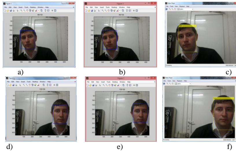
Fig. 5.22 Rezultatele urmării feței în cadrele 66 și 139 din secvența video 1 prin metodele: CAMShift (a,d), MeanShift (b,e), algoritmul Viola-Jones (c,f) [35]
