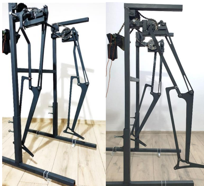
Fig. 6.11. Prototipul fizic al exoscheletului.
