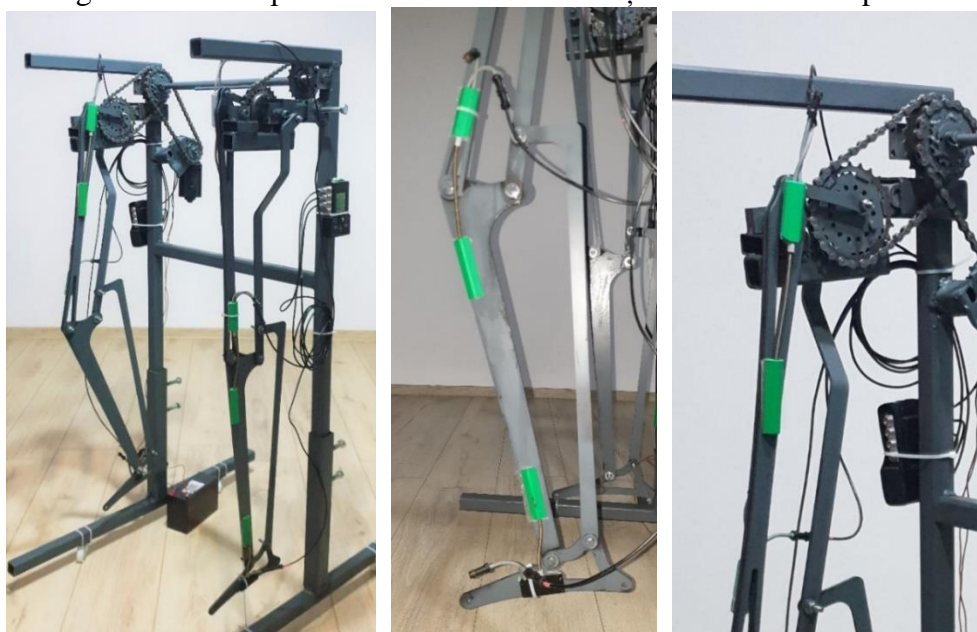
Fig. 6.16. Echipamentul Biometrics montat pe exoschelet
