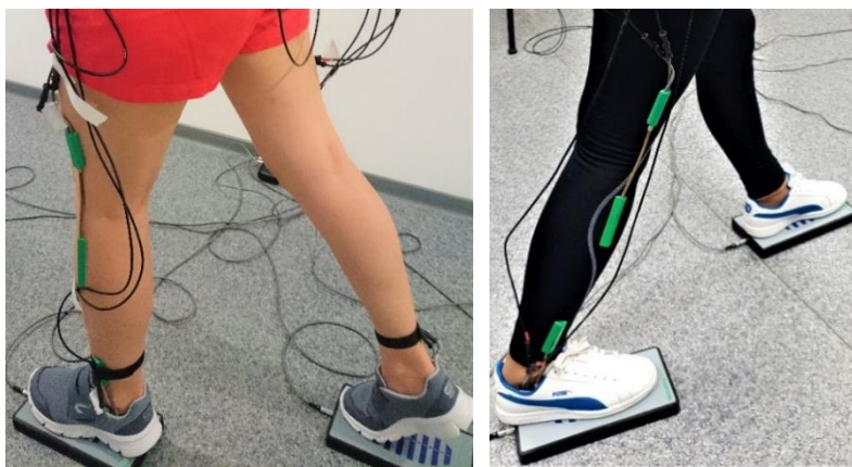
Fig. 4.2. Subiecți cu electrogoniometre și platforme de forță în timpul testelor experimentale
